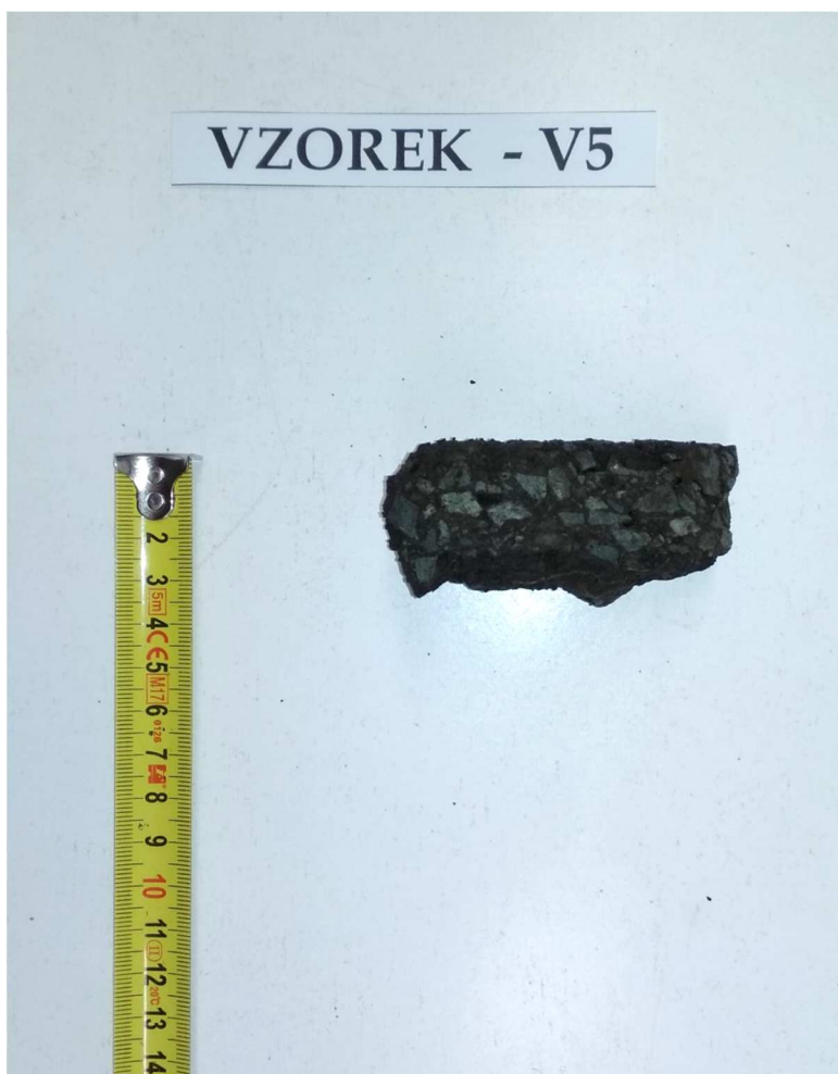
Obr. 10 - Jádru vývrtu Vzorek – V5 (laboratoř).
