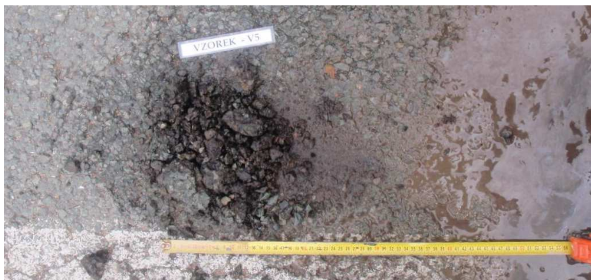
Obr. 9 - Jádro vývrtu Vzorek – V5 (in situ).
