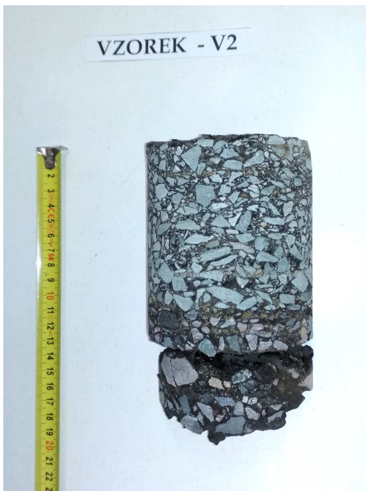
Obr. 4 - Jádro vývrtu Vzorek – V2 (laboratoř).
