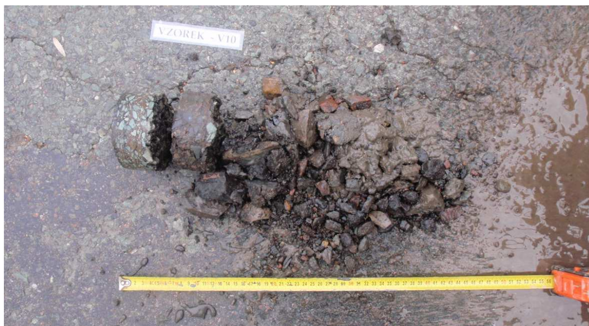
Obr. 19 - Jádro vývrtu Vzorek – V10 (in situ).
