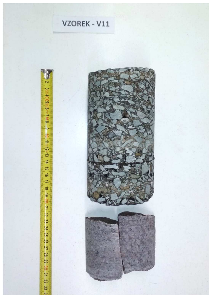
Obr. 22 - Jádro vývrtu Vzorek – V11 (laboratoř).
