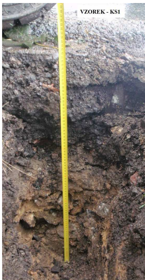
Obr. 23 - Jádro vývrtu Vzorek – KS1 (in situ).
