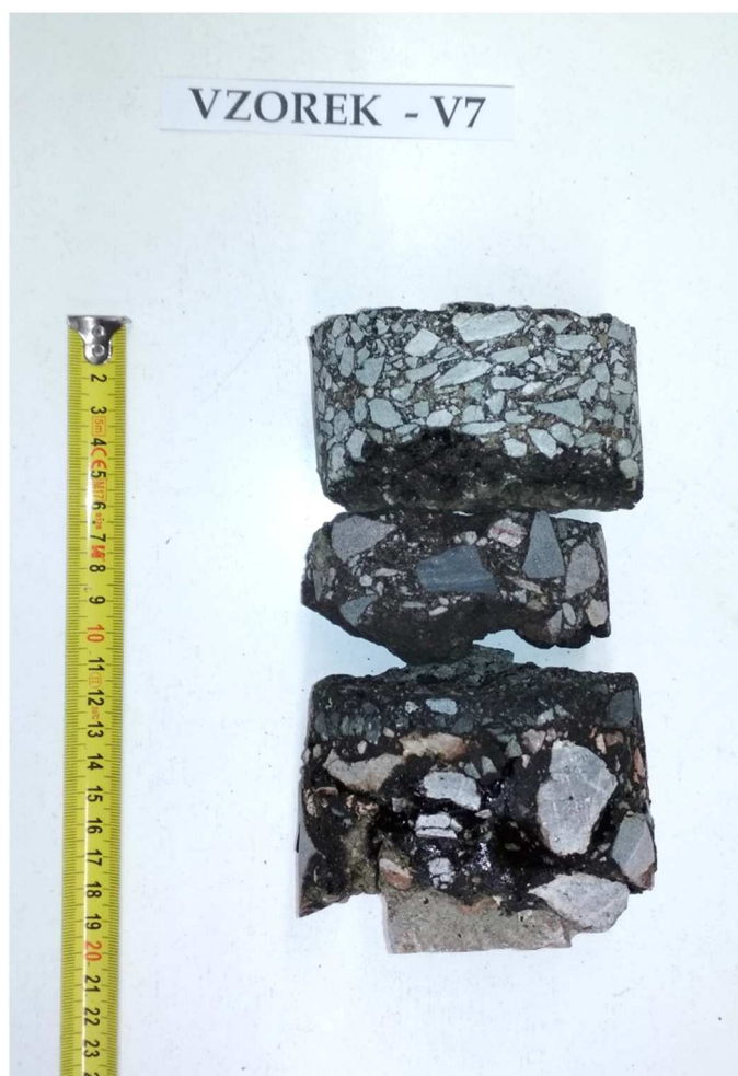
Obr. 14 - Jádro vývrtu Vzorek – V7 (laboratoř).
