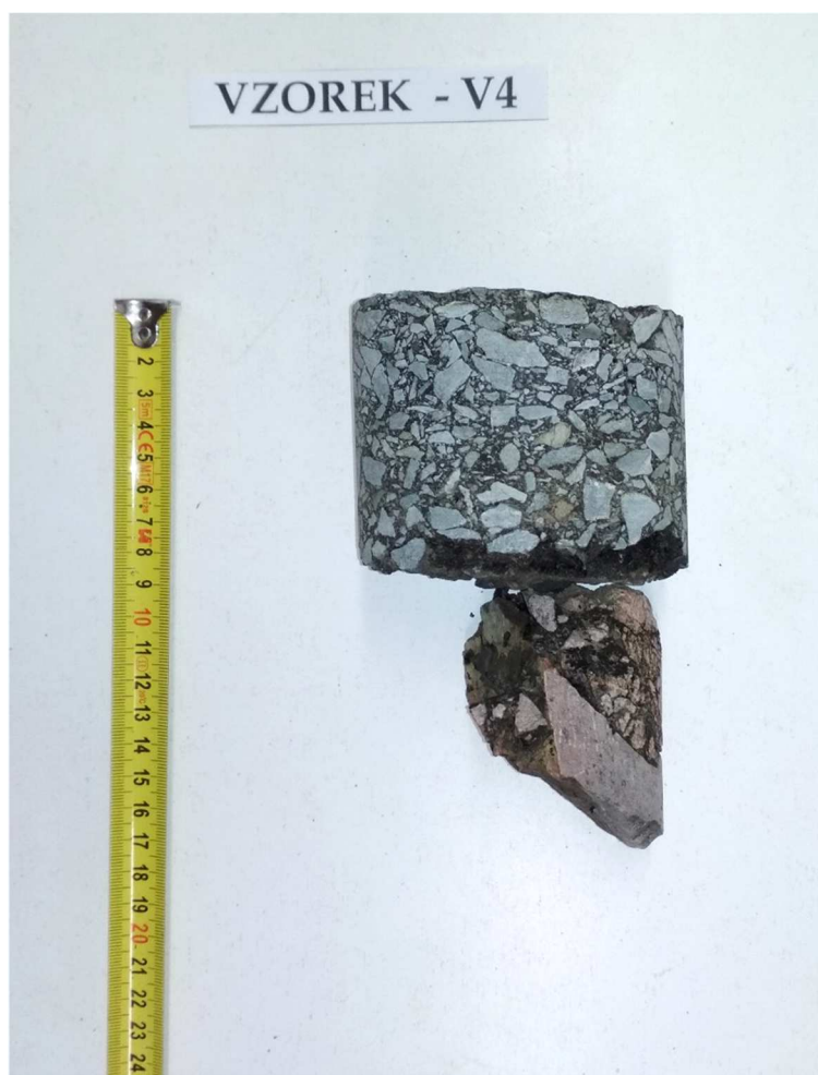
Obr. 8 - Jádro vývrtu Vzorek – V4 (laboratoř).
