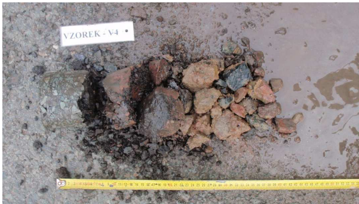
Obr. 7 - Jádro vývrtu Vzorek – V4 (in situ).
