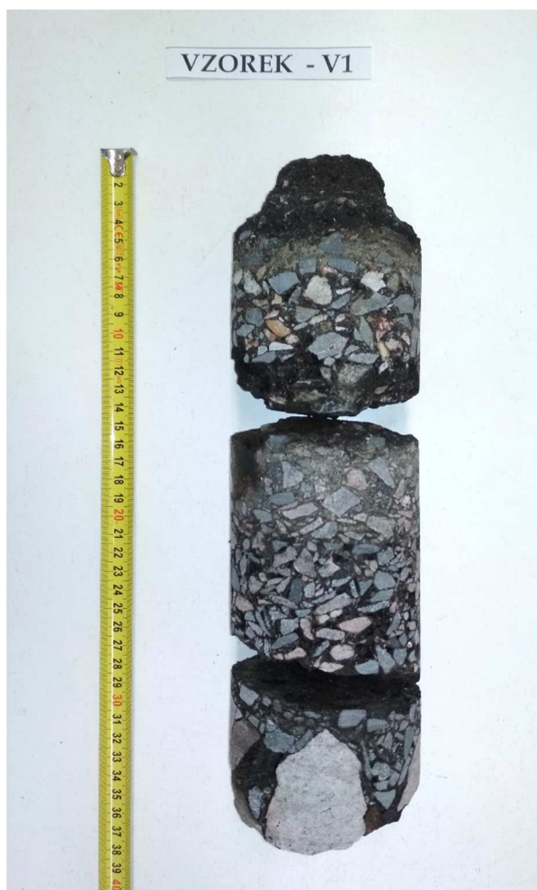
Obr. 2 - Jádro vývrtu Vzorek – V1 (laboratoř).
