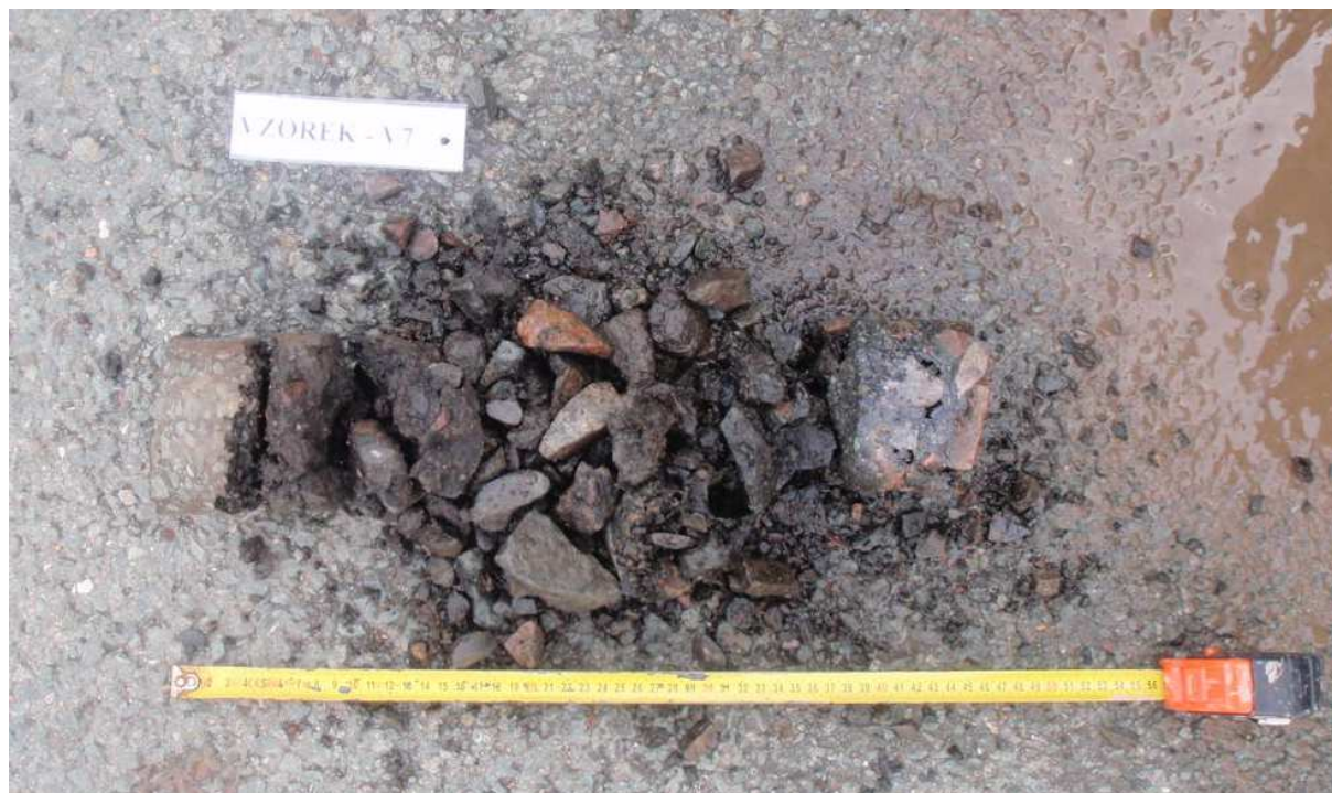
Obr. 13 - Jádro vývrtu Vzorek – V7 (in situ).
