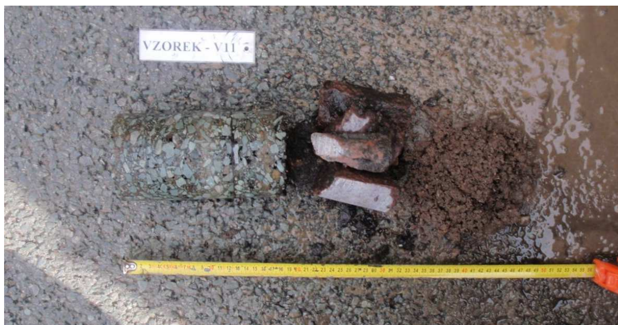
Obr. 21 - Jádro vývrtu Vzorek – V11 (in situ).
