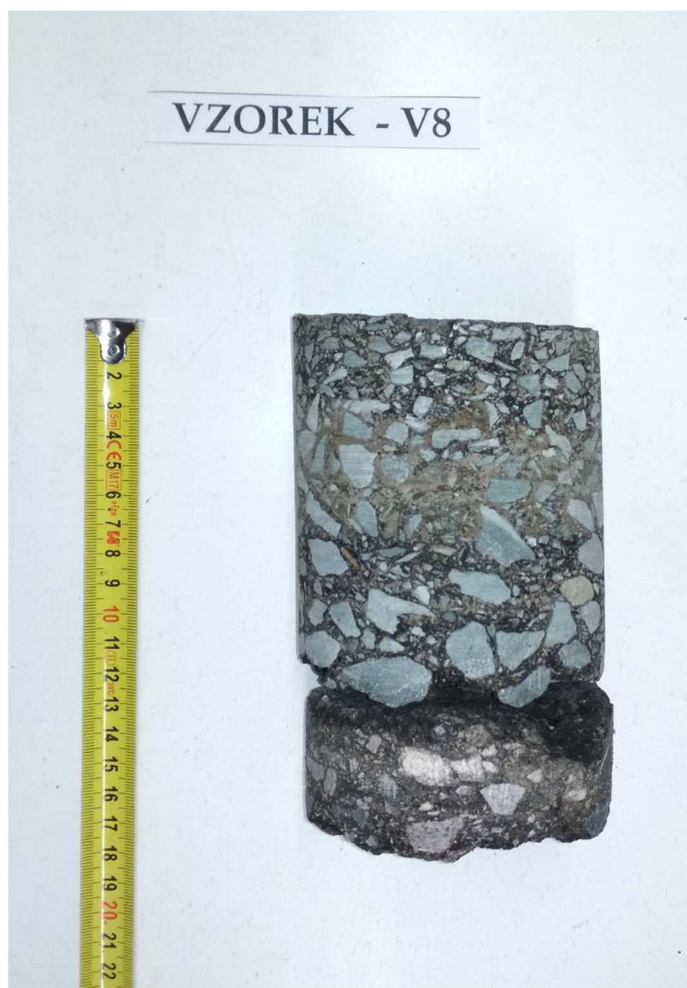
Obr. 16 - Jádro vývrtu Vzorek – V8 (laboratoř).
