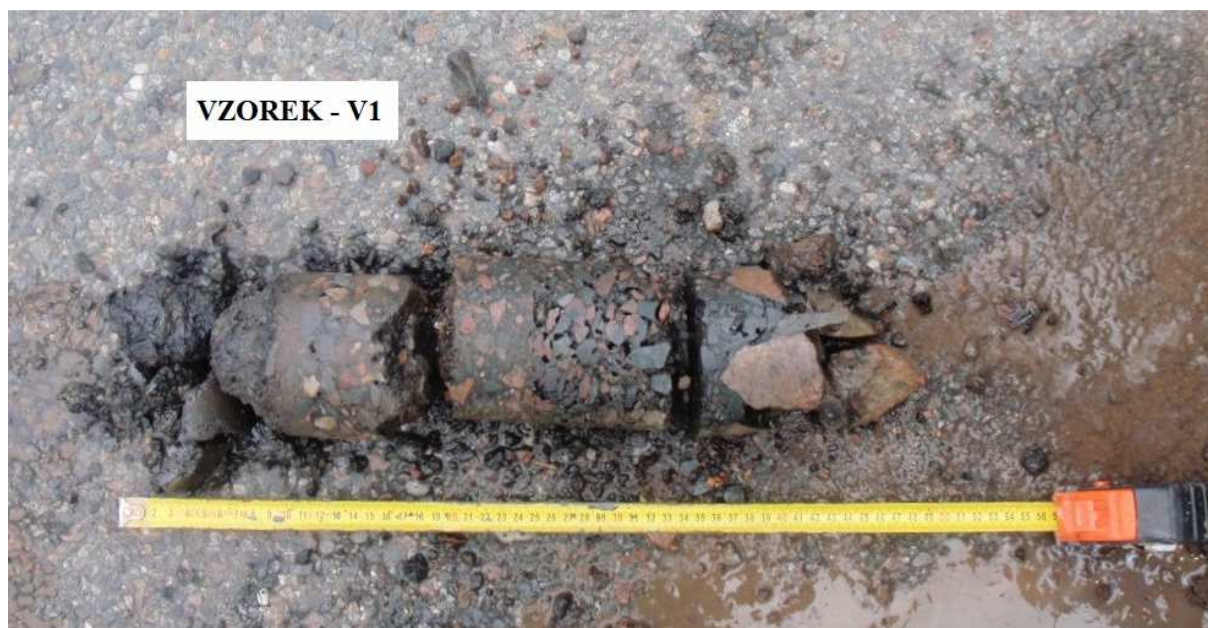
Obr. 1 - Jádro vývrtu Vzorek – V1 (in situ).
