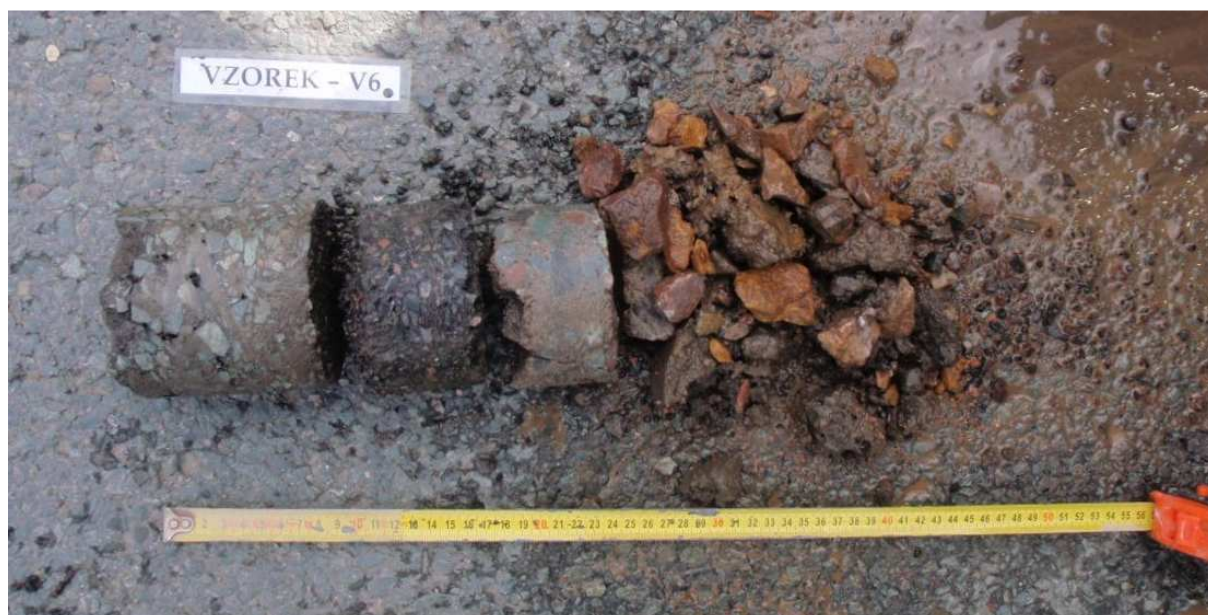
Obr. 11 - Jádru vývrtu Vzorek – V6 (in situ).
